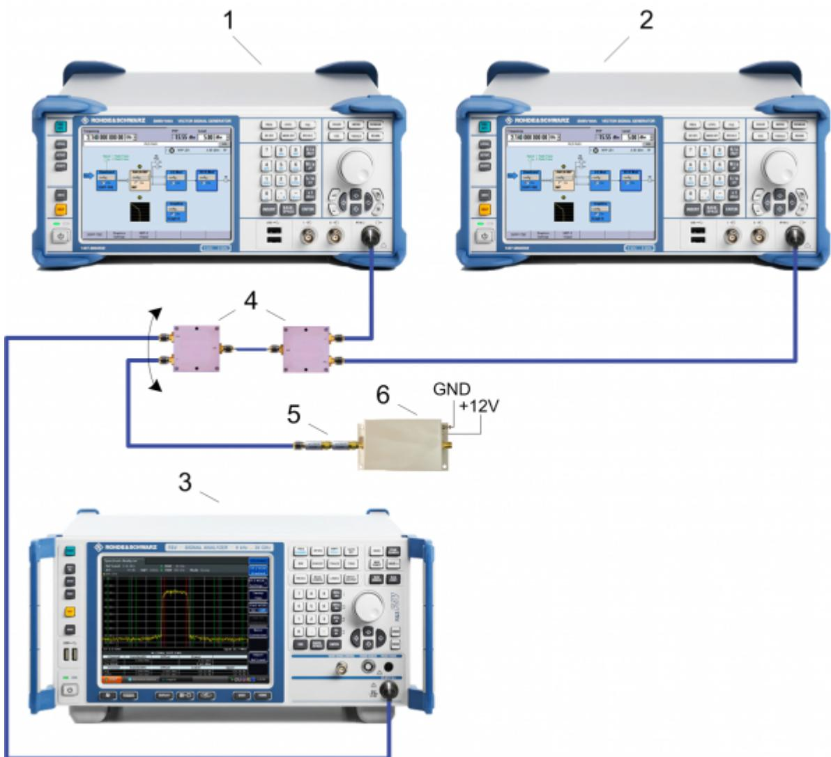
Рисунок 2 - Схема экспериментальной установки для измерения характеристик разветвителя
