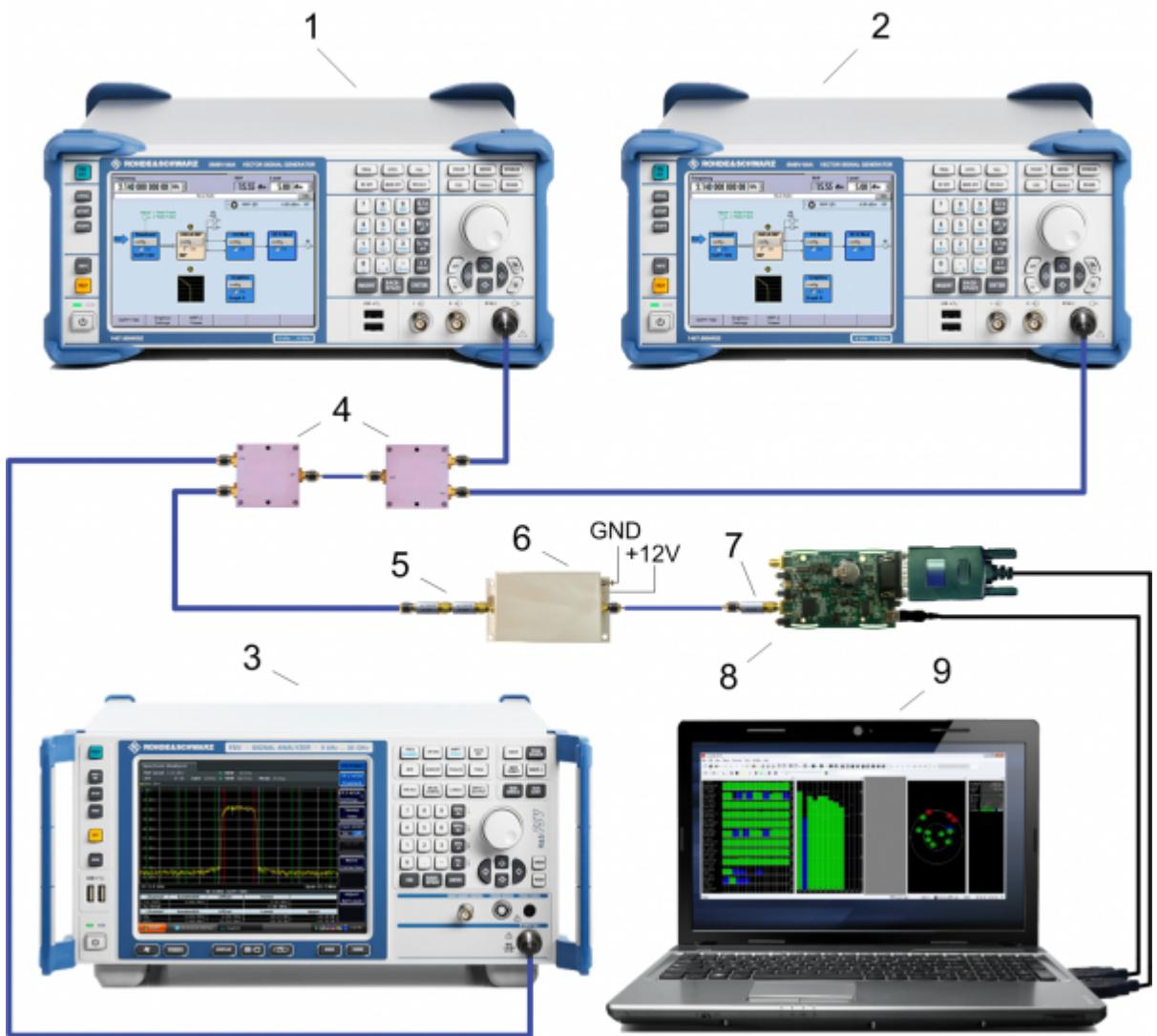
Рисунок 4 - Схема экспериментальной установки для измерения чувствительности и помехоустойчивости навигационных модулей
