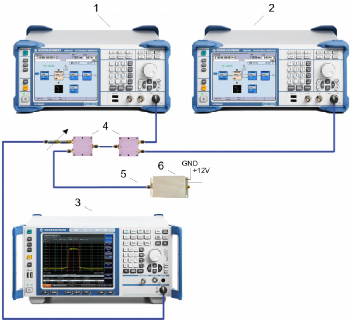
Рисунок 3 - Схема экспериментальной установки для измерения характеристик аттенюатора
