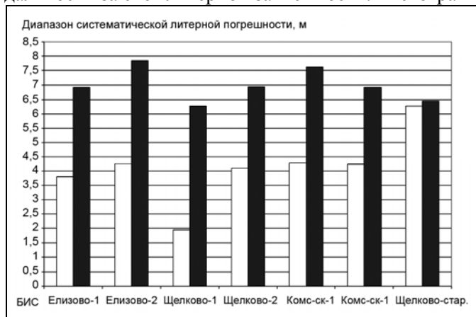
Рис. 2. Диапазон изменения систематической погрешности измерений за счет литерной зависимости: □ – VT-сигнал; ■ – СТ-сигнал
