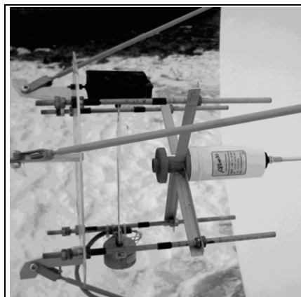
Рис. 4. Блок диаграммного сканирования на основе шагового двигателя
