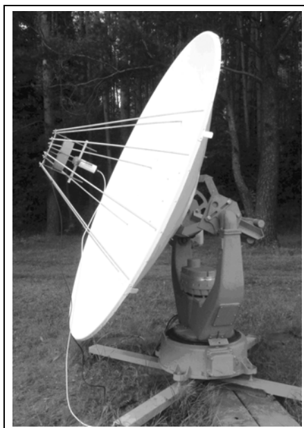
Рис. 1. Внешний вид двухзеркальной антенной системы комплекса
