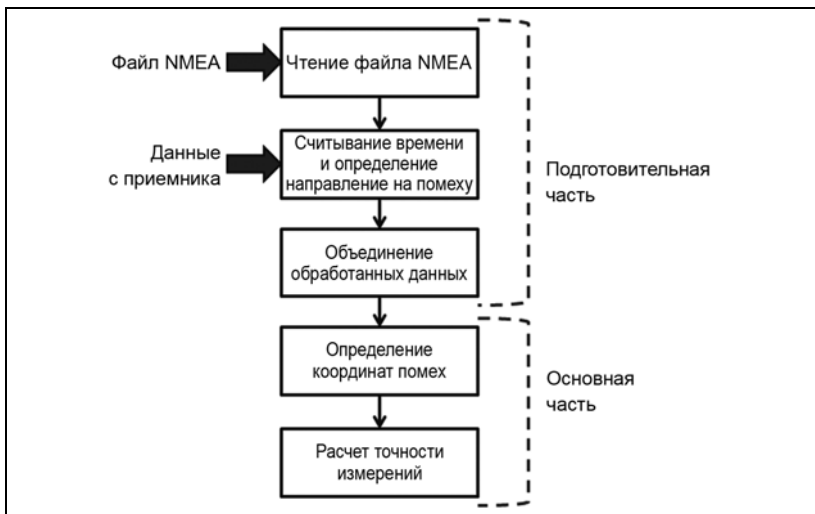
Рис. 2. Структура алгоритма определения местоположения помехи
