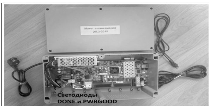
Рис. 1. Внешний вид демонстрационного образца макета вычислителя на базе ПЛИС типа FPGA серии Xilinx
