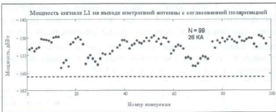
Рис. 6. Полная мощность сигнала L1 на выходе изотропной антенны с согласованной поляризацией для 26 КА ГЛОНАСС
