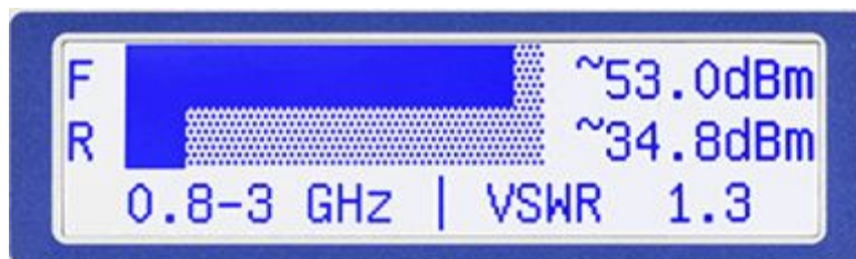
Рисунок 5-1 – BBA150-D200 – пример рабочего состояния (мощность отображается в дБмВт)
