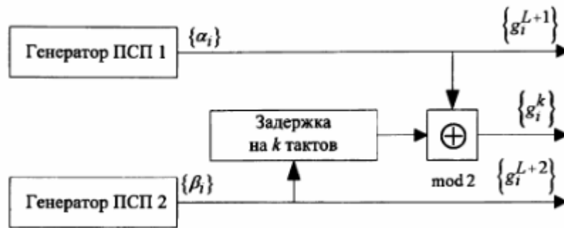
Рис.9. Схема устройства формирующего код Голда, используемый в генераторе ДК СРНС GPS.
